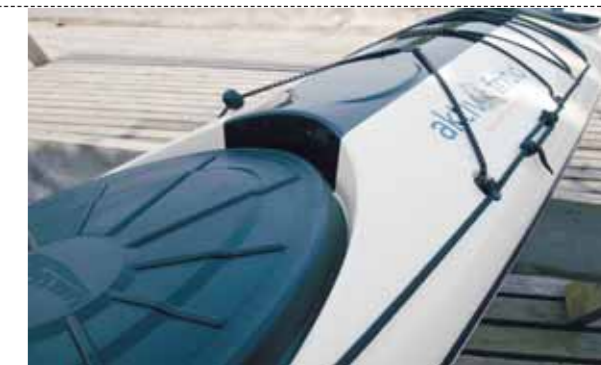
Kanten bak luken foran fører til sjøsprut i ansiktet når du padler i sterk motvind.
