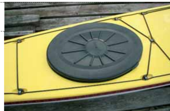
1. Ellesmere er utstyrt med gummiluker. 2. Greit justeringsjul for senkekjølen. 3. Noe uvant design på båndet som skjuler skjøten mellom skrog og dekk
